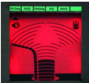
Индикатор максимума отображает максимум утечки
